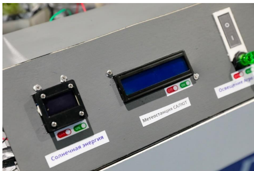
Рис. 27. Панель управления стендом с солнечными панелями, метеостанцией и освещением модели агробиолаборатории
