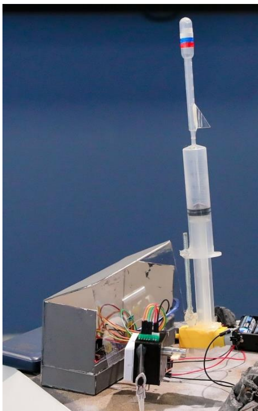
Рис. 32. Стартовый комплекс, размещённый на макете. Электронные компоненты размещены в коробке с прозрачным окошком для контроля
