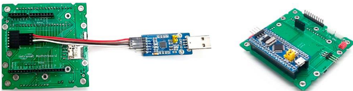
4. Подключение USBконвертора и платы BluePill к материнской плате.
